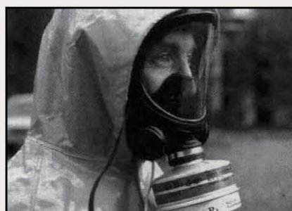
Fig. 6 Masque complet équipé d'une cartouche combinée contre les poussières et les vapeurs organiques
